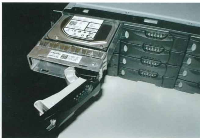
Дисковете се изваждат лесно с помощта на специални механизми
